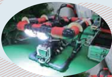
「小型無人水中観測システムの構成」 重量約 3kg、水深 50-100m まで観測可能。
