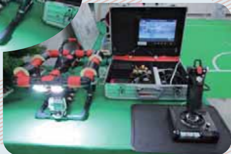
「小型無人水中観測システムの構成」 重量約 3kg、水深 50-100m まで観測可能。
