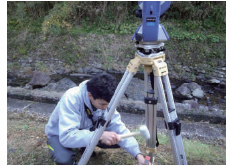
図-1 横断面測量の様子
