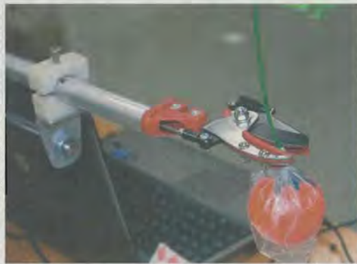
アームの先に付いた切り取りばさみを使い、トマトを収穫する日本文理大学のトマトロボット
